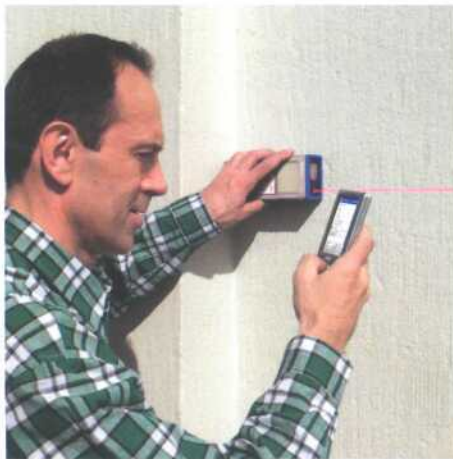
Rationelles Aufmaß: Die erfassten Daten werden drahtlos per Bluetooth vom Entfernungsmesser an den Pocket-PC übertragen
