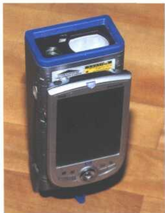
Einhandbedienung durch Befestigung des Pocket-PCs direkt am Distanzmessgerät
