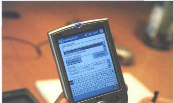
Die Zuordnung der hinterlegten Aufmaßformeln für die einzelnen Flächenarten und Räume des Objekts erfolgt am besten vor Ort. Am Bildschirm lassen sich Texte und Massen nachbearbeiten und als Messurkunde ausdrucken
